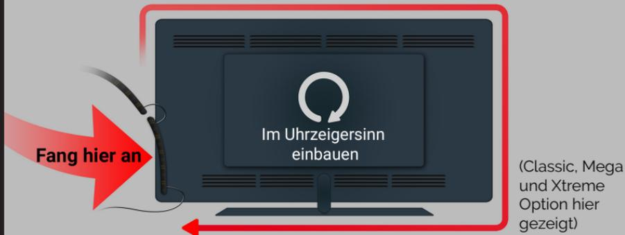
LEDs müssen von unten links an der BACK OF YOUR TV installiert werden, dann im Uhrzeigersinn fahren
