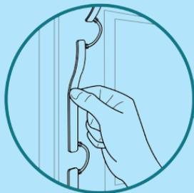
Halten Sie LEDs am Rand des Fernsehgeräts an. Die Klebstoffe sind so ausgelegt, dass sie während der Montage platziert werden können.
