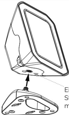
Einfache Verbindung mit Stative und Halterungen mit ¼ 20 Gewinde.
